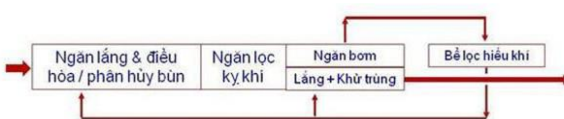
Hình 3.2: Sơ đồ nguyên lý hoạt động của bể Bastafat-f
